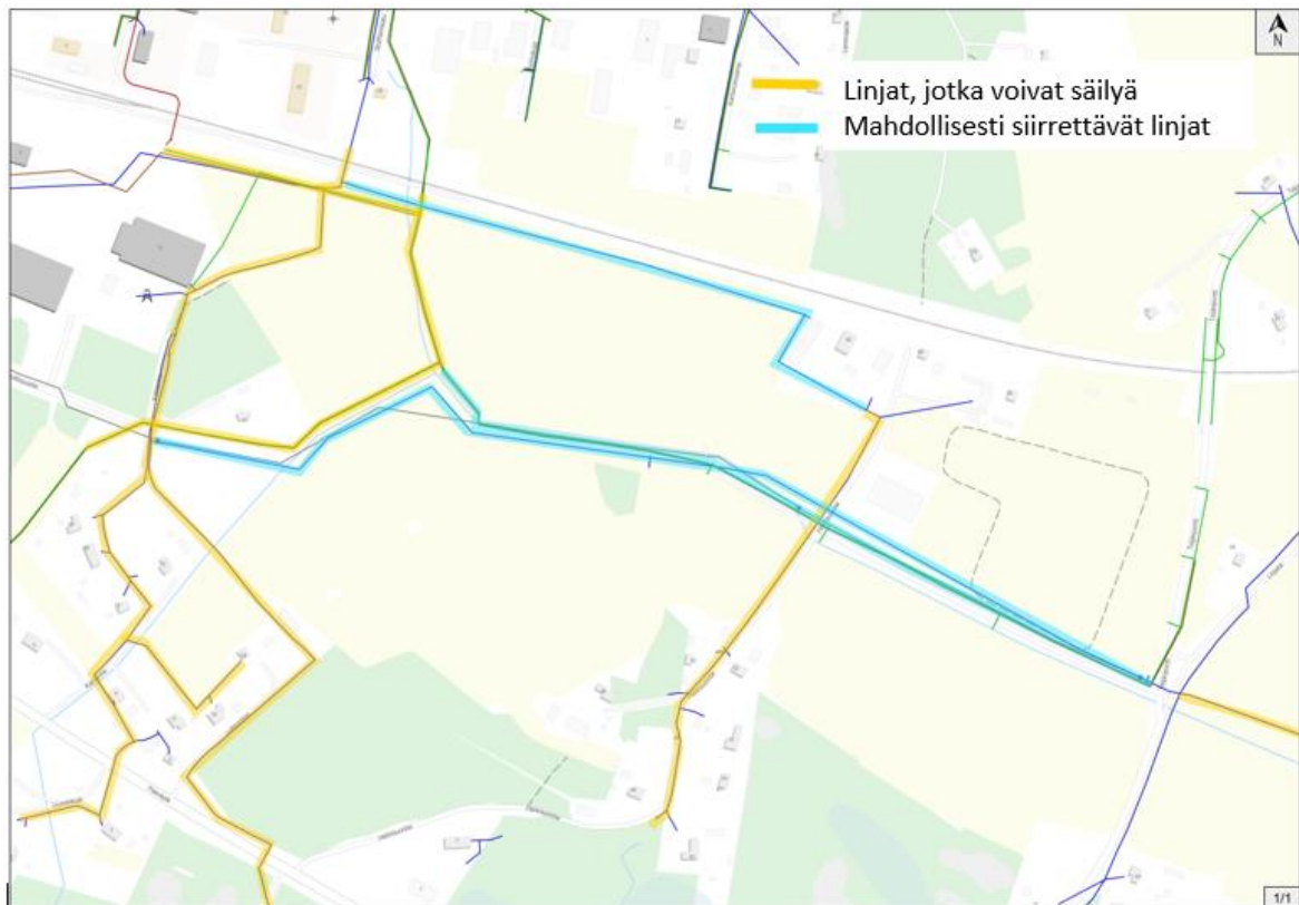
Kuva 28. Kaava-alueen vesihuollon nykyinen linjasto ja arvio rakentamisen yhteydessä siirrettävistä ja säilytettävistä linjoista. (Kokemäen kaupunki, 2022)
