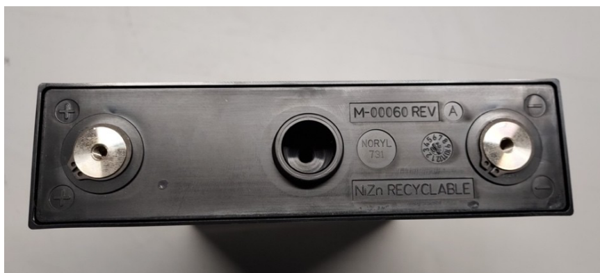
Kuva 9: Akkukennon kansiosa jossa keskellä vesiaukko, reunoilla plus ja miinus navat
