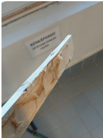
Kuvat 50a...c. Rakenneliittymissä havaittiin kosteuden aiheuttamia jälkiä sekä pintarakenteissa että runkorakenteiden (puurunko/apukarmit) sisäpinnoilla.
