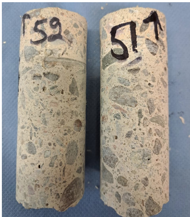
Kuvat 92 a ja b. Näytteet N51 ja N52 tasausaltaan ulkopinnasta. Näytteen ulkopinnassa on pinnoite. Näytteiden betonissa tai betonin raudoitteessa ei havaittu silmämääräisesti viitteitä vaurioitumisesta. Betonin ulkopinnassa on silmämääräisesti arvioituna karbonatisoitunut alue, jonka syvyys on noin 30 mm.
