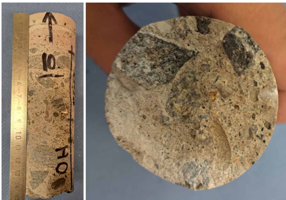
Kuvat 35 a ja b. Näyte N10 altaan pohjasta. Näytteessä on pintarakenteet, joiden alla noin 20 mm:n pintavalu/korjauslaastia. Näytteen murtopinta leikkaa kiviainesten läpi.
