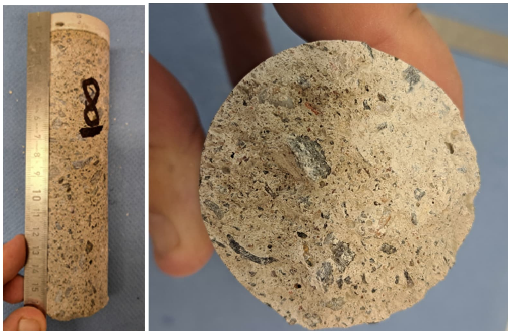
Kuvat 33 a ja b. Näyte N8 altaan seinästä. Näytteen kiviaines on silmämääräisesti arvioituna huomattavasti pienempää muihin näytteisiin nähden.
