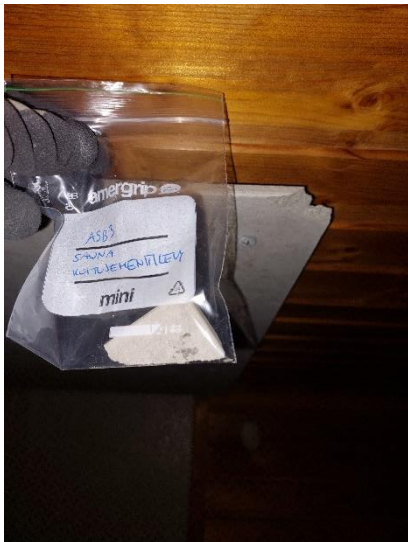
Kuva 3. Näyte ASB3 (Sisäverhouslevy/palosuojauslevy, saunan katto, kuitusementtilevy (8 mm, ruuvikiinnitys)) ei sisällä asbestia.
