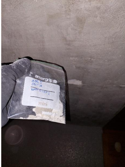
Kuva 5. Näyte ASB5 (tasoite + kevytbetoni) ei sisällä asbestia.
