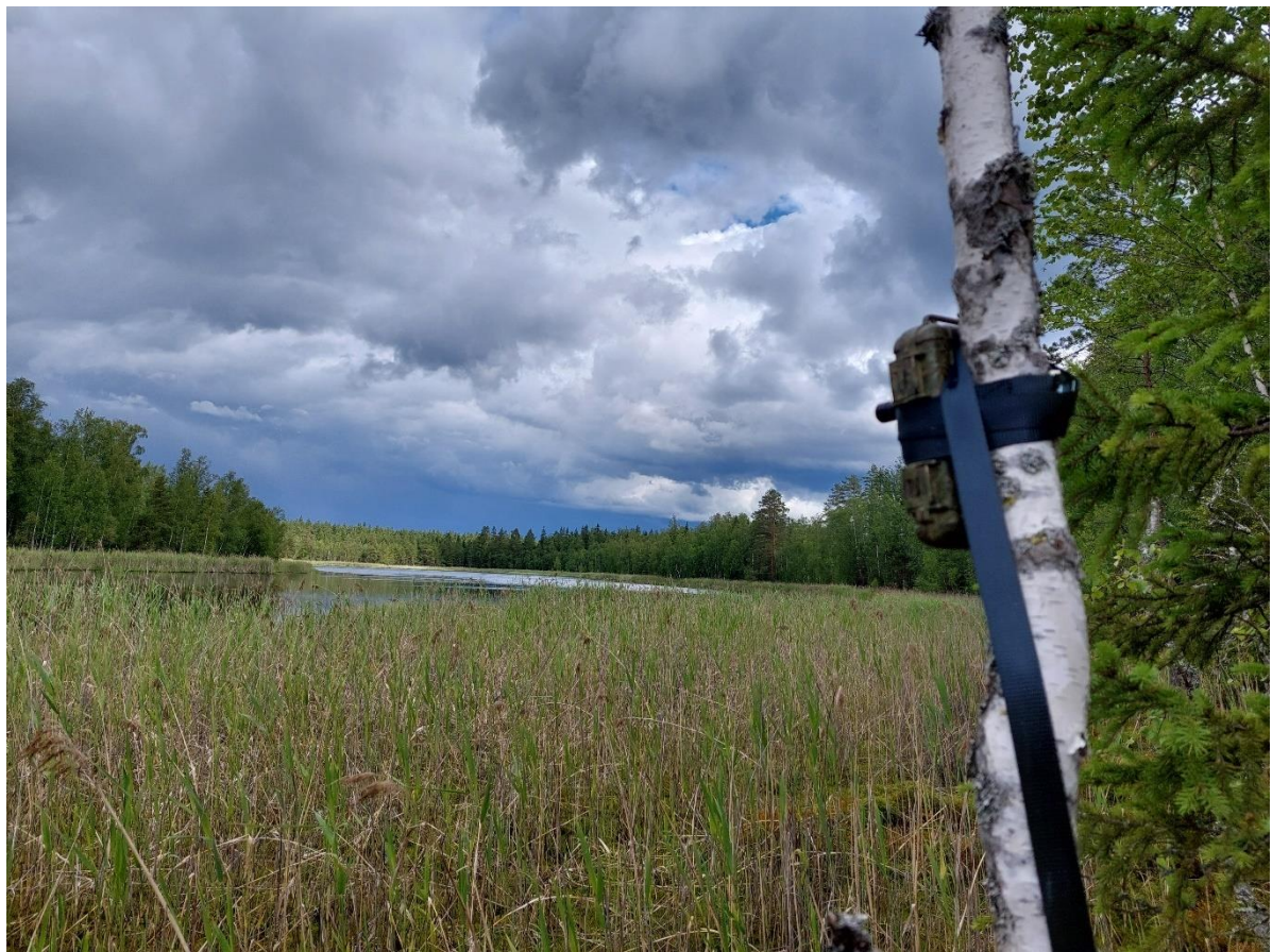
Kuva 46. Passiivilaitepaikka 3. Anabat passiivitalennin Matinjärven eteläpäässä puuhun asennettuna.
